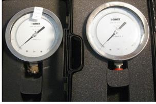
La ditta Maccini & Bellini effettua prova di tenuta serbatoi, verificando la pressione con manometro
